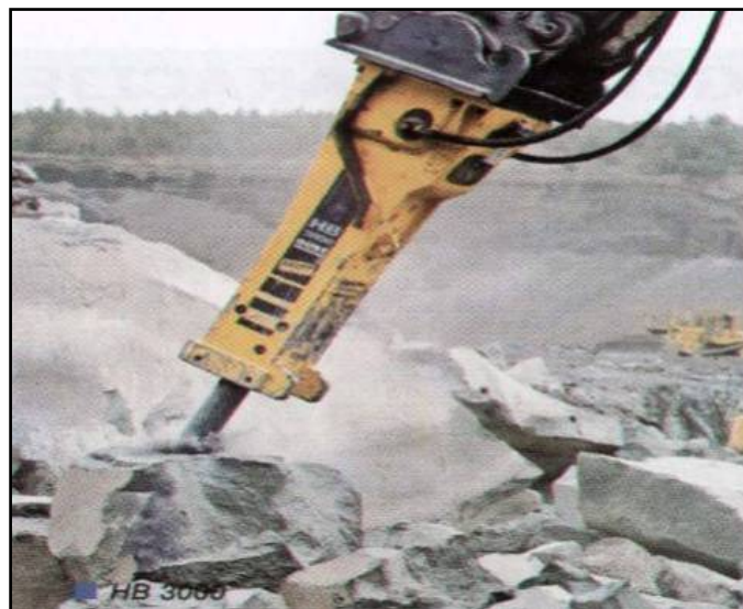
Слика 44: Уситњавање негабарита хидрауличним чекићем
